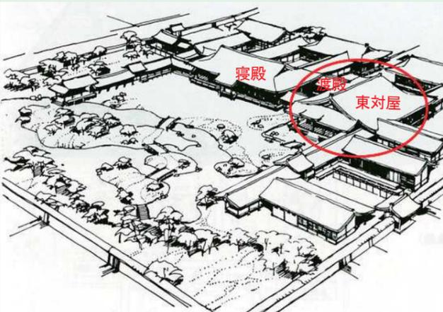
「東三条殿」想定復元図 赤丸が「対屋」、寝殿とは渡殿で結ばれている
